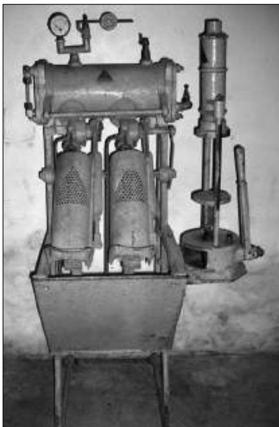
Antigua llenadora de gaseosas, de las llamadas "de brazo" (Fotografía del autor)
