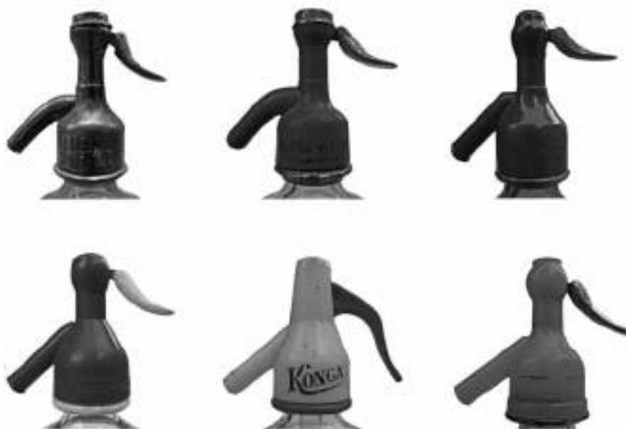
Diferentes tipos de cabezas (de arriba abajo y de izda. a dcha.): de peltre, de peltre esmaltada al fuego, de calamina, de nylon, de plástico y de plástico con gran palanca (Col. Museo Etnológico de Navarra)
