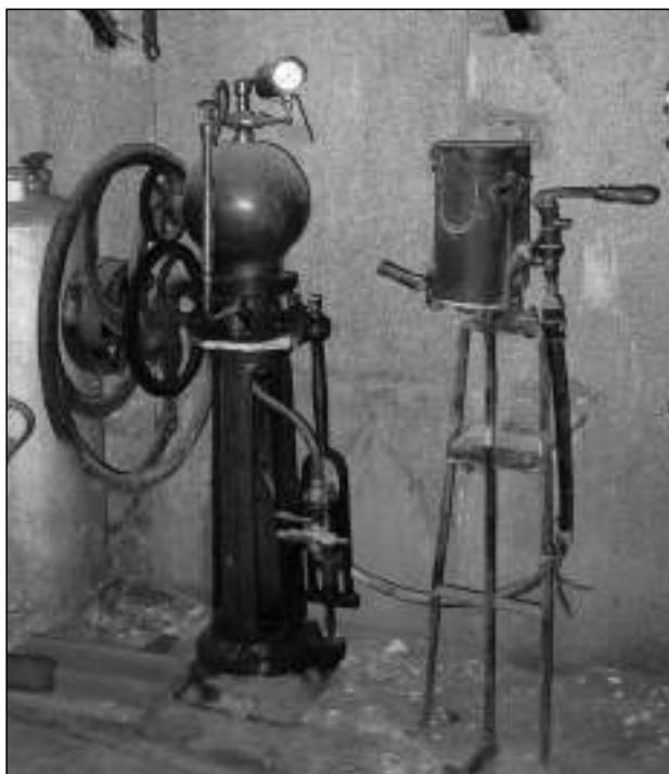
Saturadora y llenadora de sifones en una antigua fábrica de gaseosas (Fotografía del autor)
