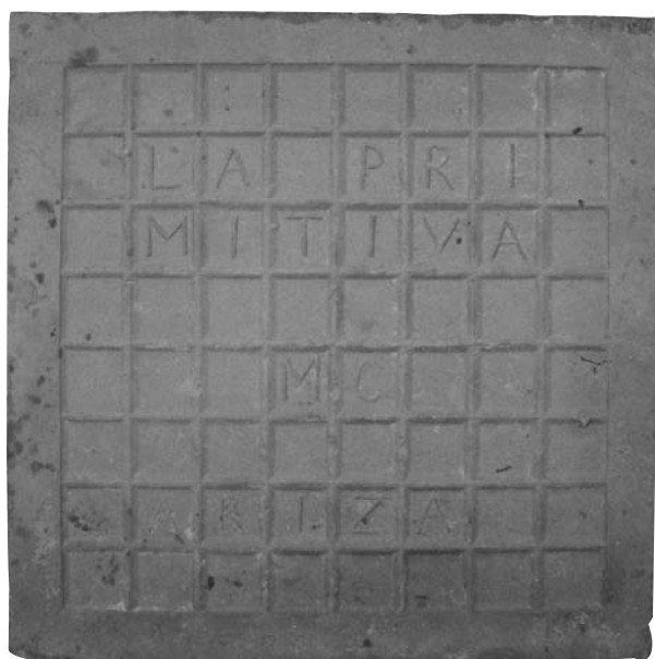
Típico reverso con forma de rejilla de un baldosín de Ariza (Col. del autor)
