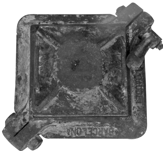
Molde completo antes de ser introducido en la prensa (Col. Museo Etnológico de Navarra)
