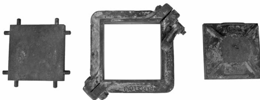
Molde desmontado en donde se aprecian, de izquierda a derecha, las tres piezas que lo forman: base, marco y tapón (Col. Museo Etnológico de Navarra)
