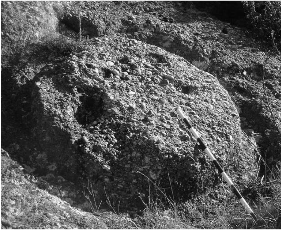
Fig. 7. Muela “sin terminar de sacar” en las canteras de San Vicente de Robres (La Rioja).
