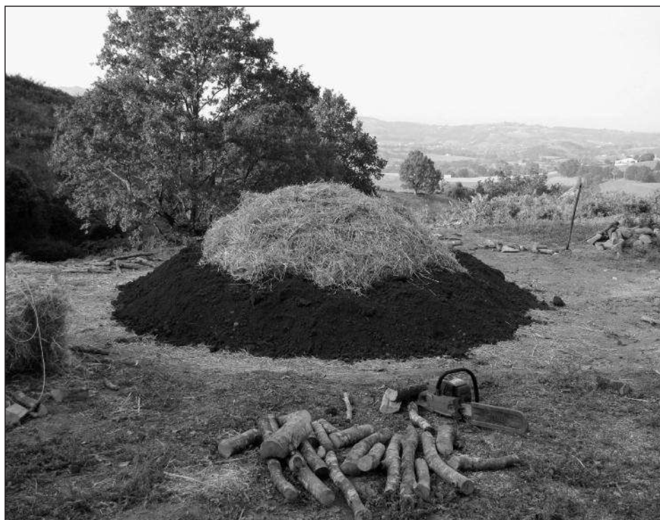
Cubrimos de paja y tierra (Foto: A. Agirre y M. Duvert).
