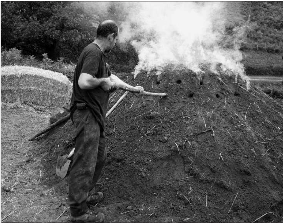
Haciendo los agujeros o respiradores laterales (Foto: A. Agirre y M. Duvert).
