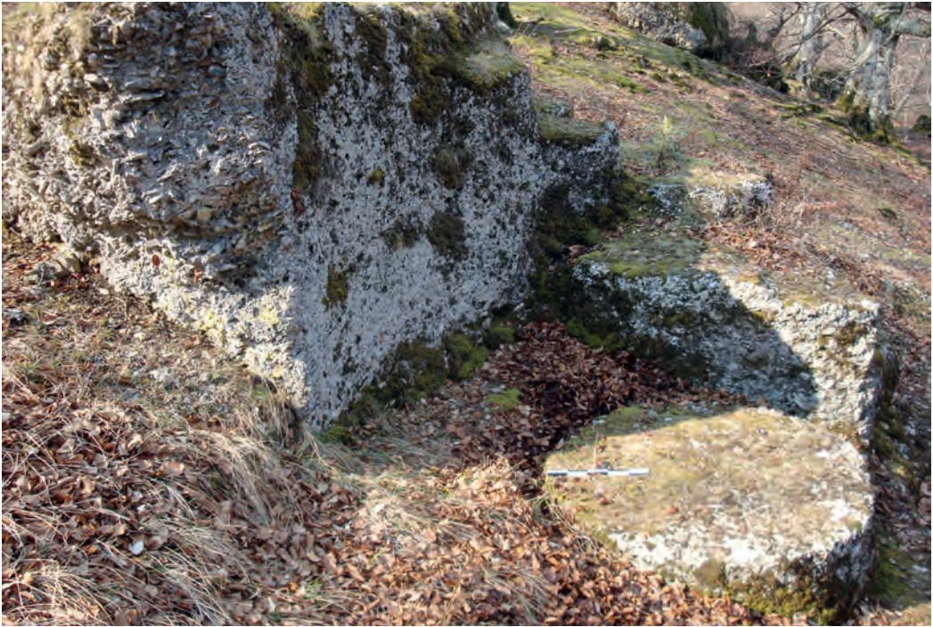
Figura 43. Muela y frente de extracción en forma de gradas. Cantera Olabekotedi (Uharte Arakil). Imagen de los autores.
