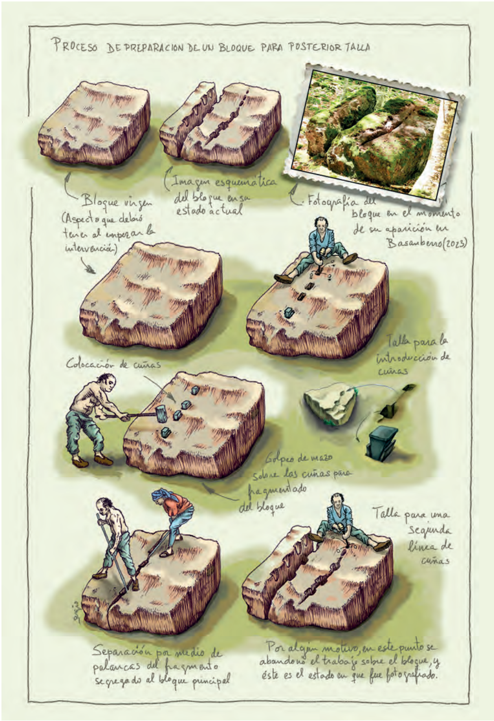
Figura 51. Simulación del proceso de preparación de la talla de un bloque, cantera zona de Basanberro (Estearibar). Imagen de Sergio Díez.
