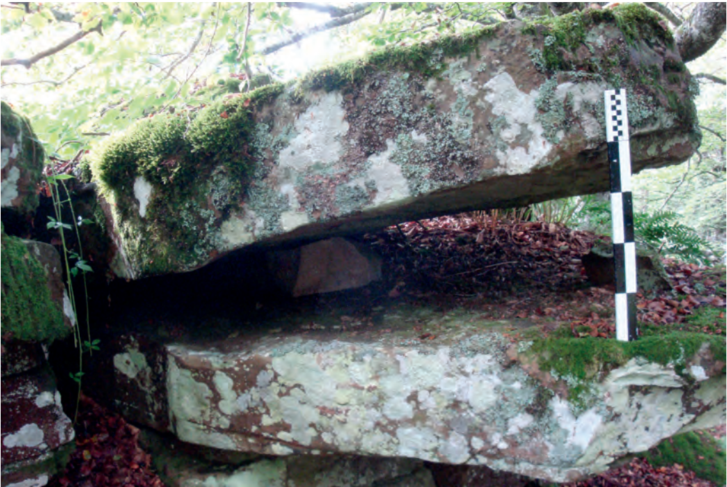
Figura 50. Losa levantada y calzada para obtener una muela, cantera Arpeiku (Garaioa). Imagen de los autores.
