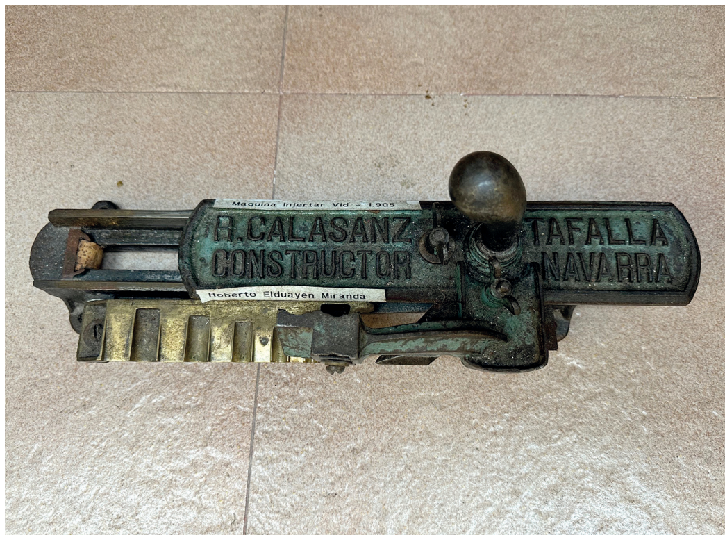
Figura 3. Injertadora de sarmientos de Roberto Elduayen, fabricada en Tafalla en 1905.
